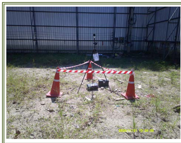
รูปที่ 3-12 การตรวจวัดความสั่นสะเทือน บริเวณพื้นที่โครงการ
